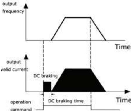
DIAGRAM P2-3 STARTING DC BRAKING DIAGRAM
